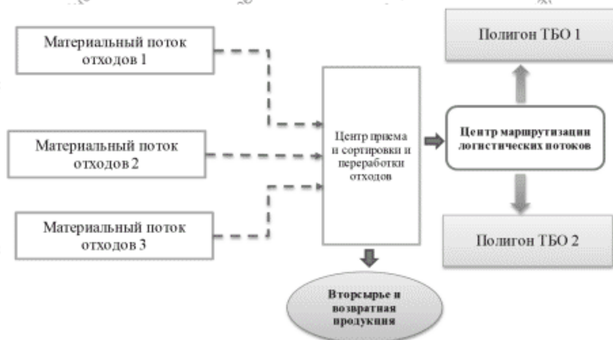
Рисунок 4 - Схема логистических потоков с использованием центра сортировки и переработки отходов
