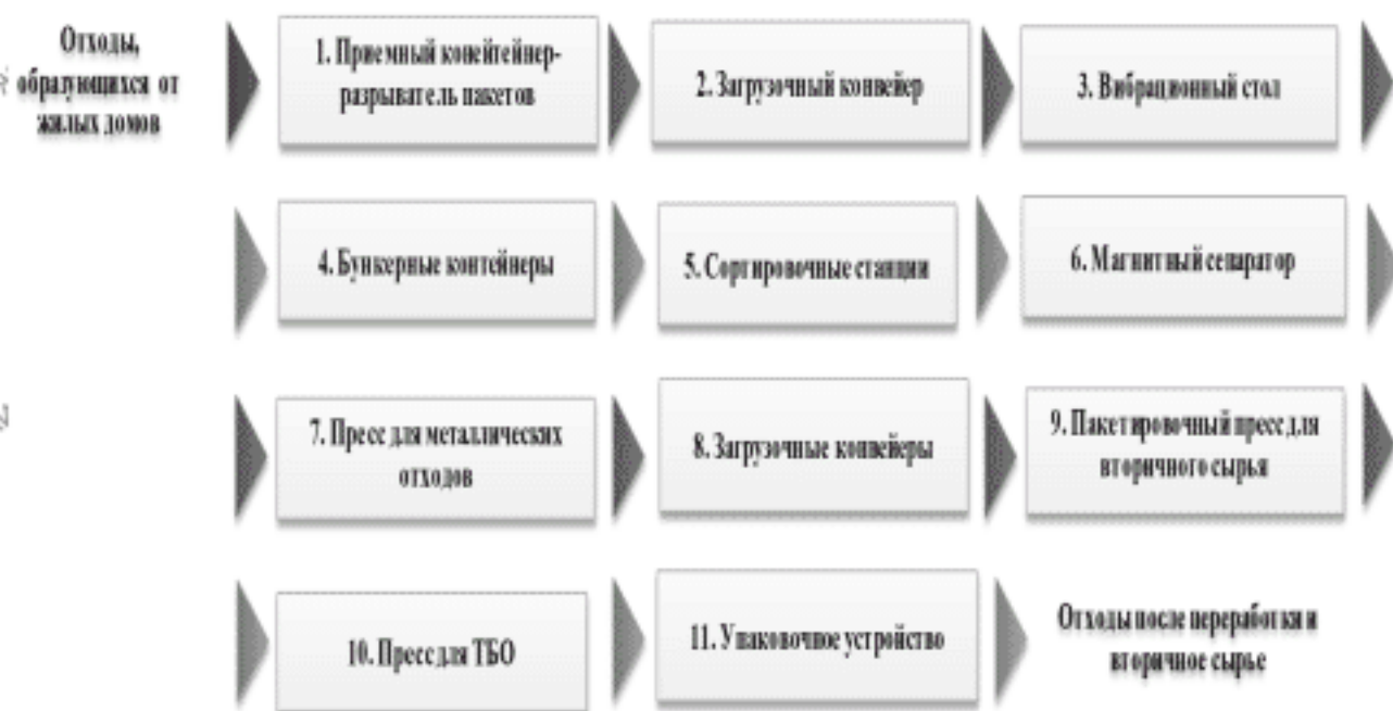
Рисунок 5 - Схема этапов переработки отходов на сортировочной станции
