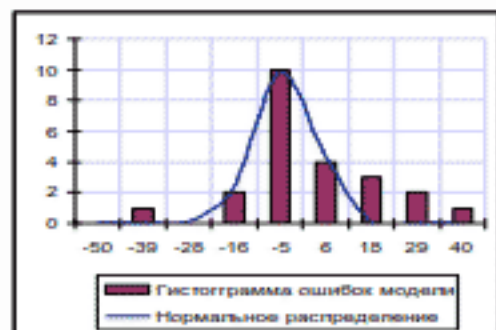
Рисунок 4 - Распределение ошибки математической модели и ее оценка с помощью нормального закона распределения
