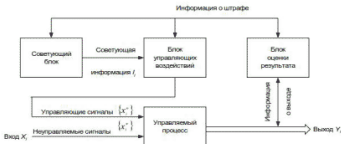
Рисунок 3 – Схема системы управления
