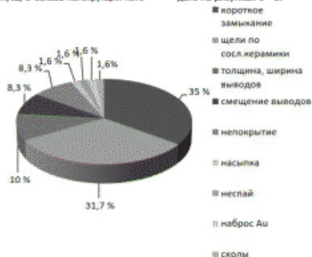
Рисунок 1 - Дефекты корпуса ДКИ 4М-5Х7Х-5К за 2016 год
