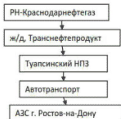
Рисунок 1 – Модель производственно-технологической цепочки южного подразделения ОАО Роснефть «от скважины до АЗС»
